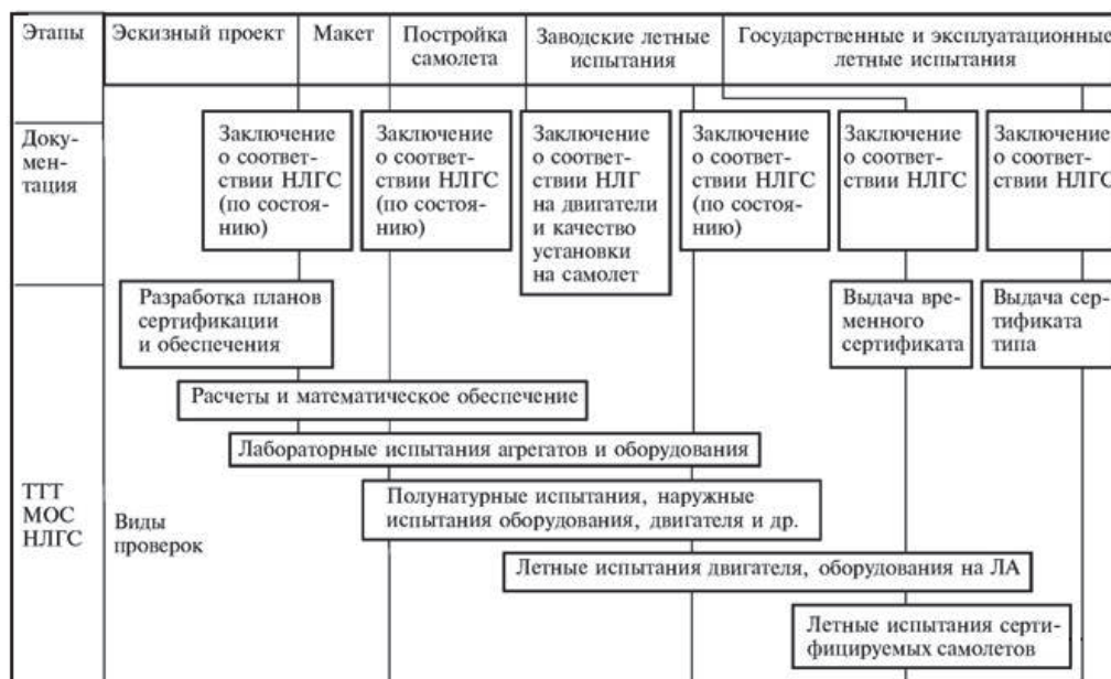
Рисунок 2 – Общая программа сертификации летательных аппаратов (ТТТ – тактико-технические требования, МОС – методы определения соответствия, НЛГС – нормы летной годности самолетов)
