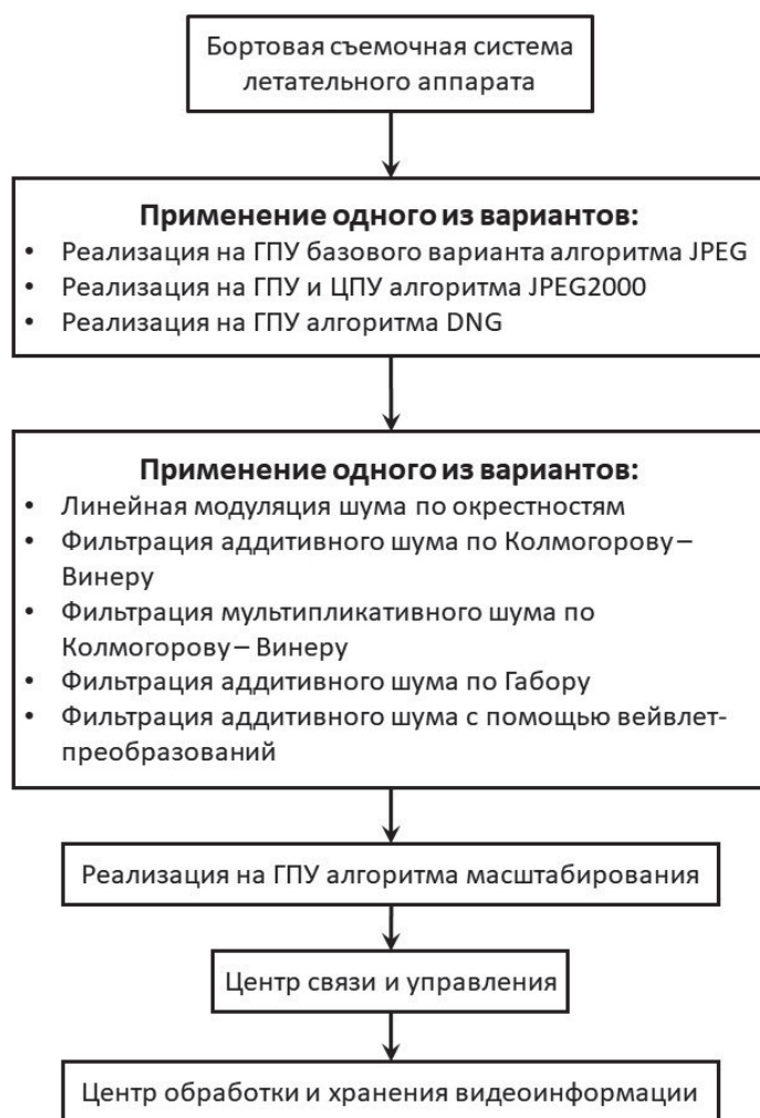
Рисунок 1 – Полный цикл цифровой обработки видеoinформации, поступающей от БСС ЛА (схема 1)
