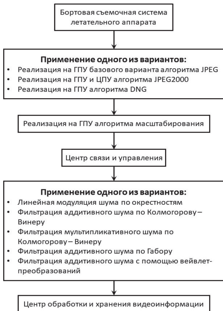
Рисунок 3 – Цифровая обработка видеоинформации, поступающей от БСС ЛА, при которой дополнительная фильтрация шума осуществляется в наземных центрах (схема 3)
