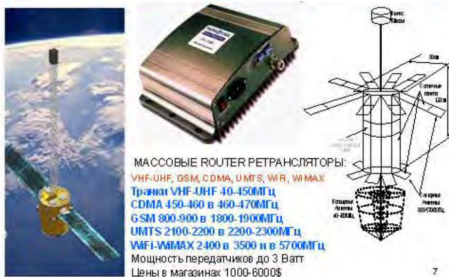
Рисунок 2 – Внешний облик низкоорбитального спутника и полосы частот наземных операторов
