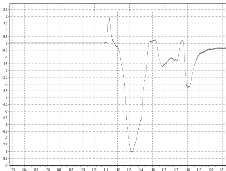
Рисунок 4 – Поведение сигнала при переходе ИК в состояние обрыва
