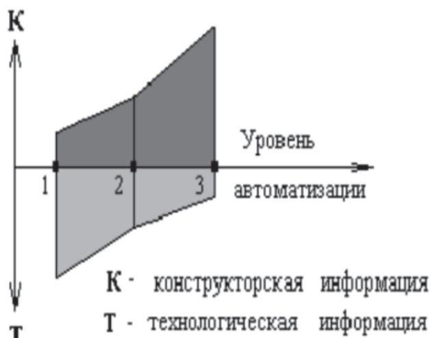
Рисунок 3 – Соотношение вводимой технологической и конструкторской информации в зависимости от уровня автоматизации
