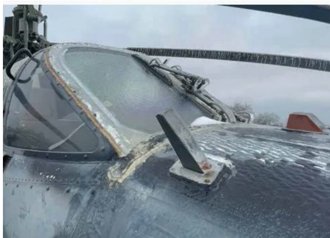
Рисунок 5 – Образование прозрачного льда на вертолёт
