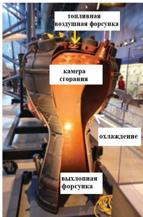
Рисунок 5 – Разрез камеры сгорания жидкостного ракетного двигателя
