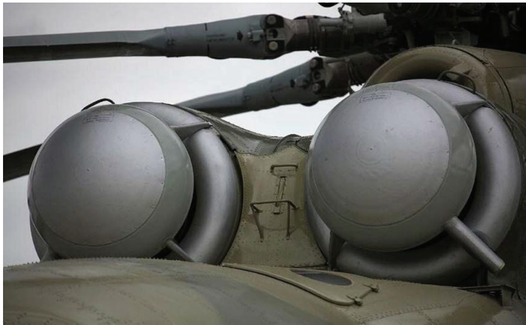
Рисунок 12 – Обогреватели воздухозаборников двигателей
