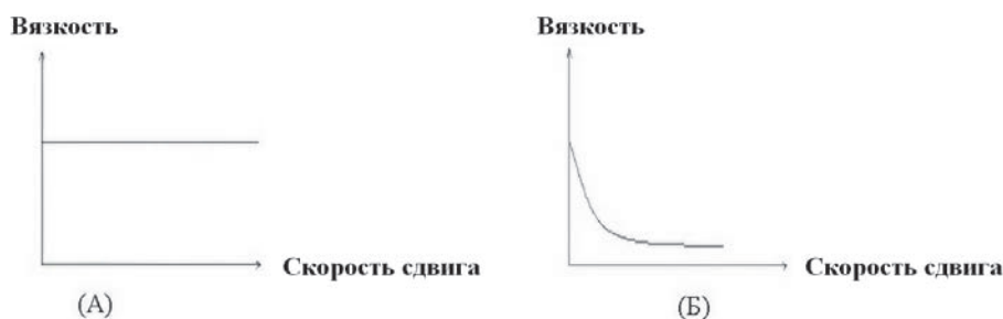
Рисунок 6 – Зависимость вязкости от скорости относительного сдвига слоев: А) для ньютоновской жидкости; Б) для неньютоновской жидкости
