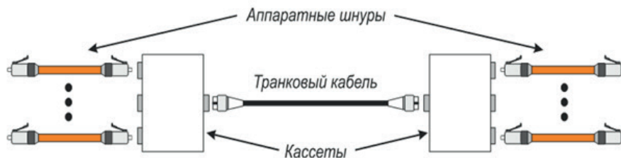
Рисунок 6 – Структура простого волоконно-оптического тракта, построенного с использованием модульно-кассетной техники
